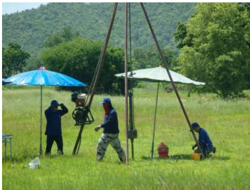
การสำรวจดิน เพื่อตรวจสอบการรับน้ำหนักของชั้นดิน
