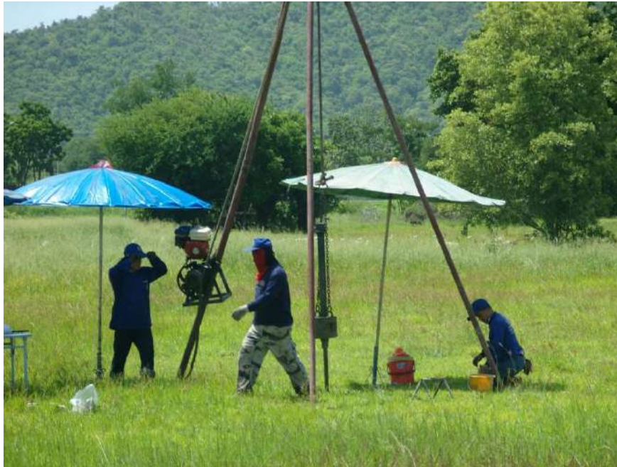
การสำรวจดิน เพื่อตรวจสอบการรับน้ำหนักของชั้นดิน
